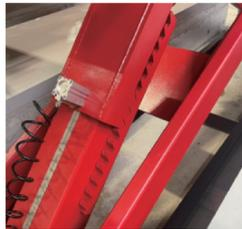
13段階のエア式安全ロック付きで測定調整作業も安心整備！
